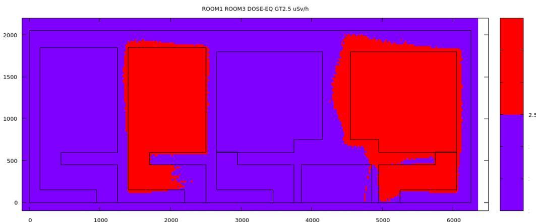
图 5-11 1#、3#机房运行时辐射剂量率大于 2.5 $\mu$ Sv/h 的区域(单位： $\mu$ Sv/h)
