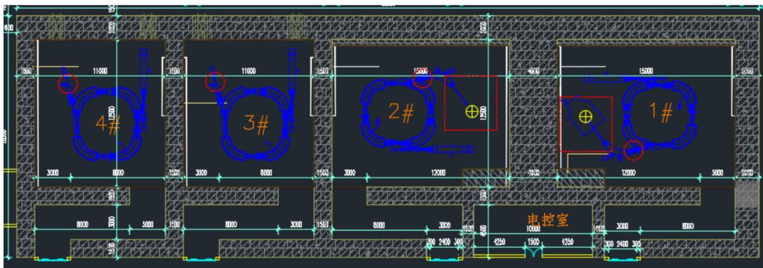
图 5-17 隔离带设置的位置（图中红虚线区域）
