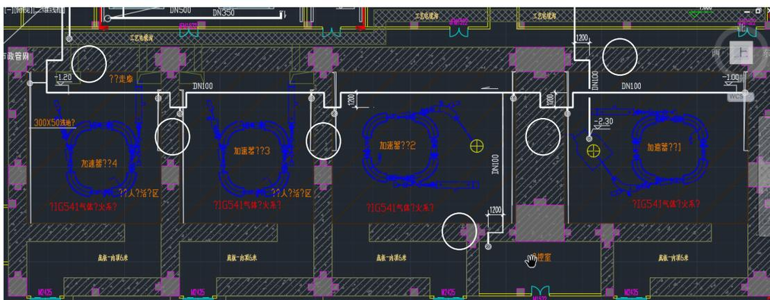
图 5-17 地漏管道穿墙设计图
