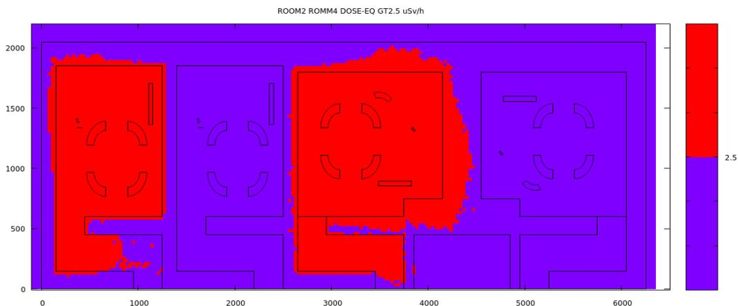
图 5-13 2#、4#机房运行时辐射剂量率大于  $2.5\mu\text{Sv/h}$  的区域(单位:  $\mu\text{Sv/h}$ )
