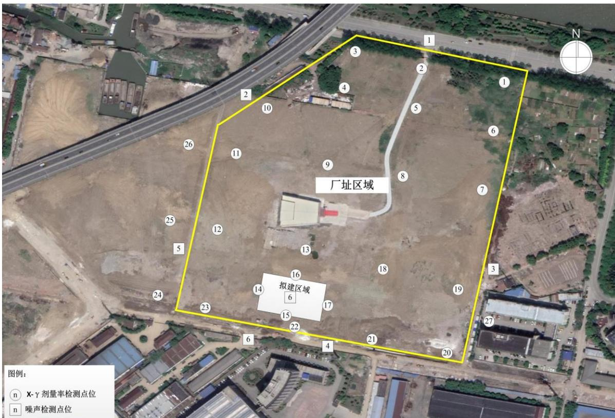
图 2-2 X-γ 剂量率及噪声监测点位示意图
