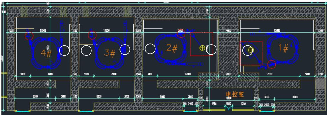
图 5-14 相邻加速器机房辐射剂量率计算点位图示意图
