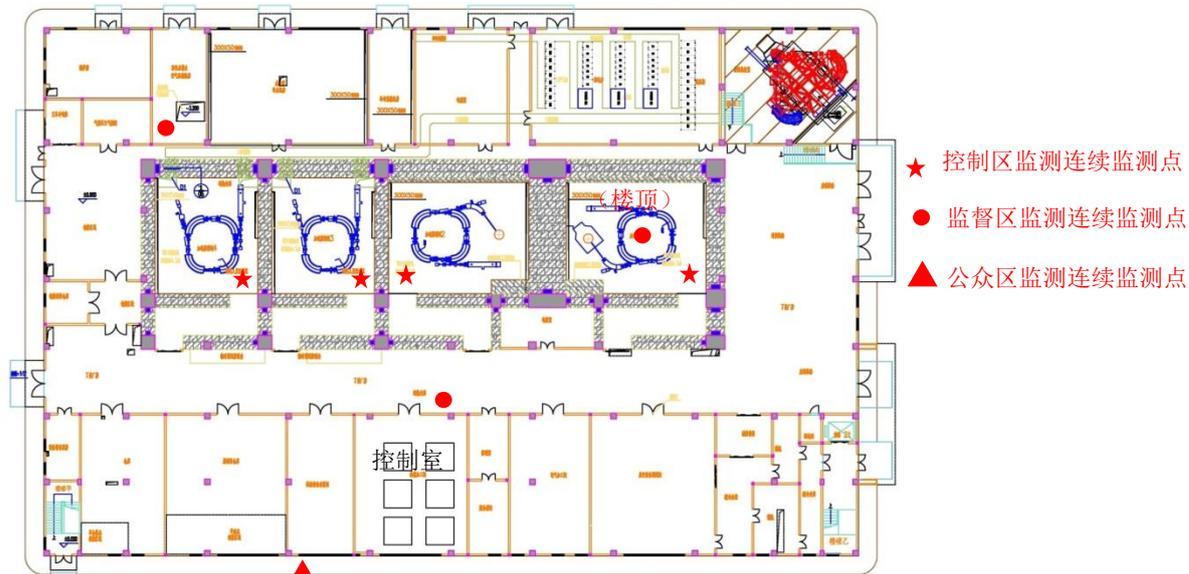
图 6-1 辐射剂量连续监测点位布置图
